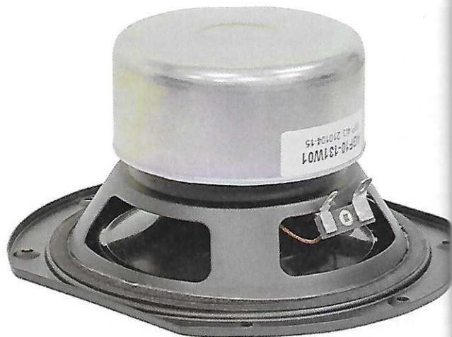
*Il midrange è forse il componente che maggiormente ha caratterizzato il test. Diametro da 5", flangia frontale tagliata sopra e sotto per ridurre la distanza tra i centri acustici con il tweeter, vista anche la frequenza di incrocio particolarmente elevata. Notate la schermatura del campo magnetico la cui utilità nell'anno 2022, francamente, fatico un po' a capire.*
