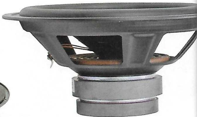
*Il woofer è sembrato un componente particolarmente riuscito. Notate il cestello in lamiera stampata ed il secondo anello magnetico di diametro leggermente ridotto per meglio controllare il flusso magnetico disperso.*
