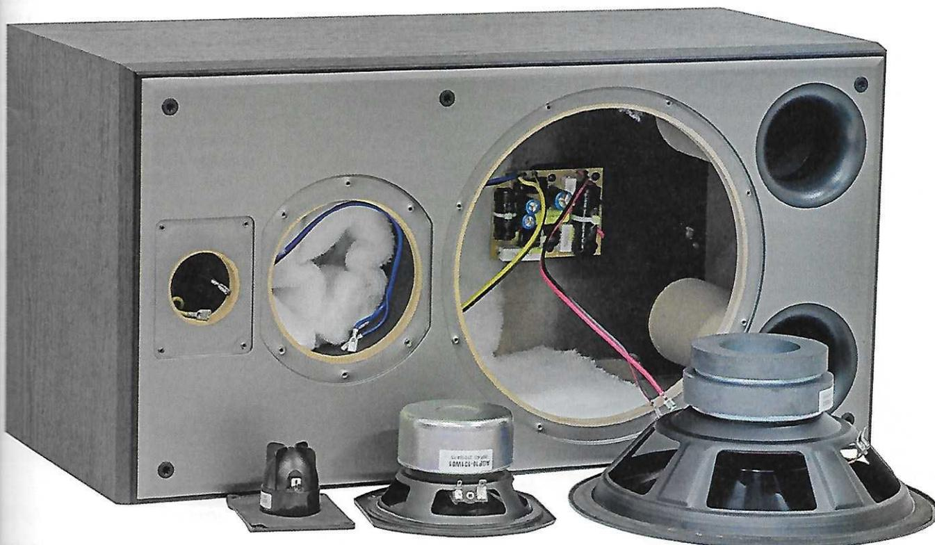
diffusore completamente smontato. Notiamo l'assorbente acrilico che riveste l'interno sia del volume occorrente al woofer che quello, molto più piccolo e cilindrico, che costituisce il carico per il midrange.
