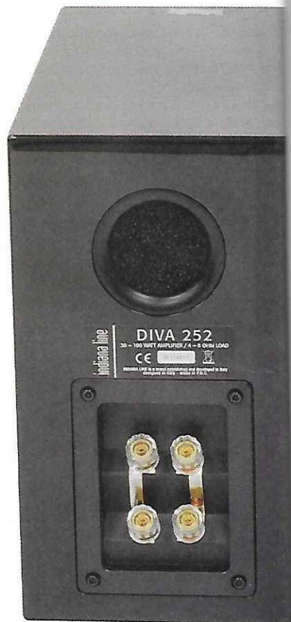
Il retro del diffusore. Notiamo il doppio cablaggio ed il condotto di accordo ben raccordato, di diametro e lunghezza notevole.
